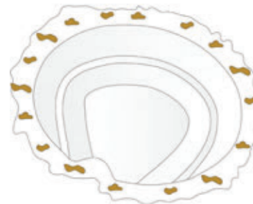
Стъпка 3 – Почистване на изкопа и полагане на приготвен слой
